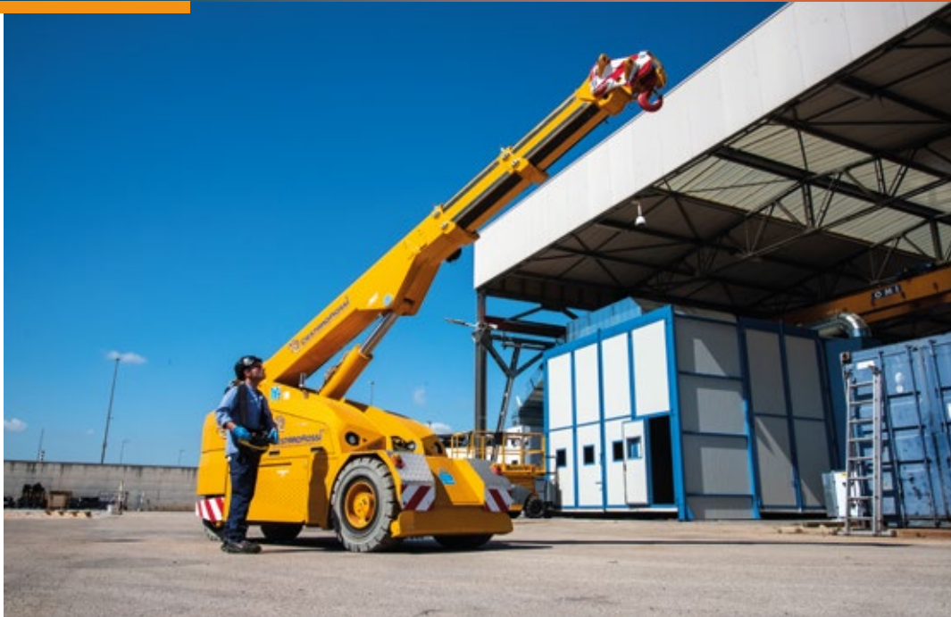
GRU ELETTRICA A COMANDO REMOTO
