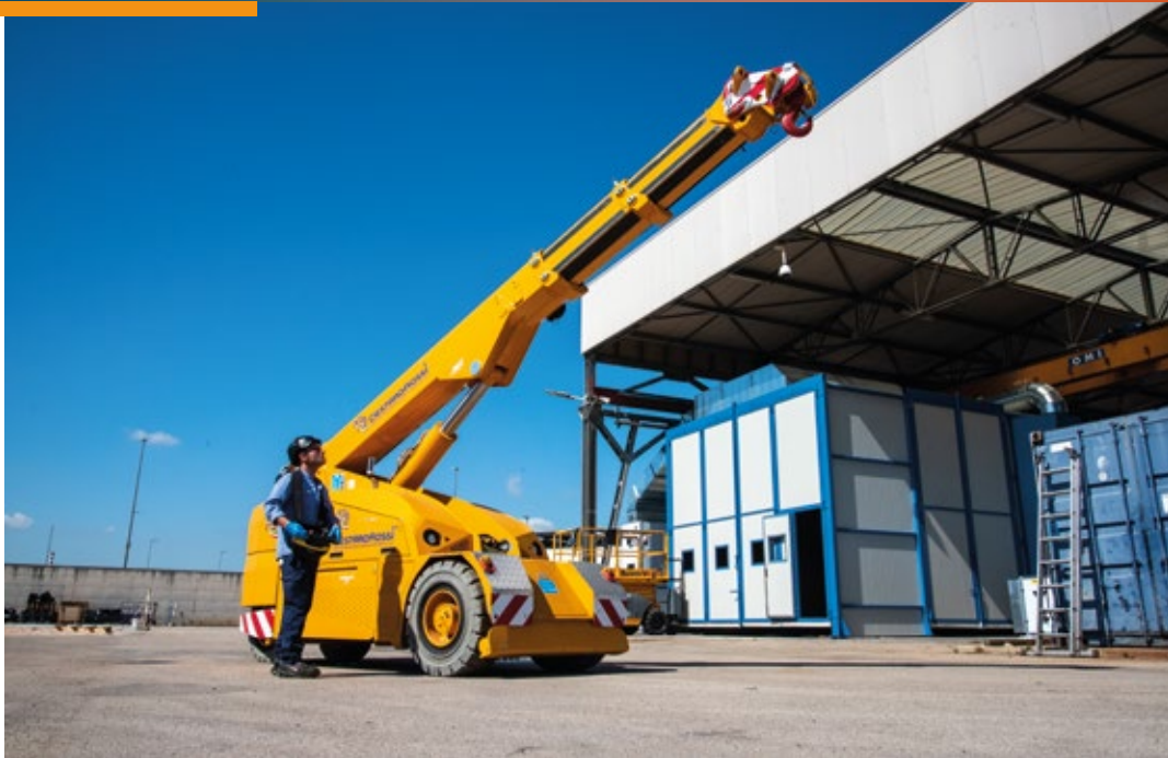
GRU ELETTRICA A COMANDO REMOTO
