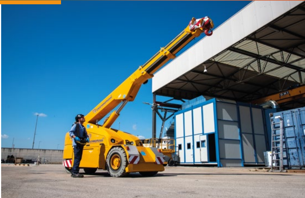
GRU ELETTRICA A COMANDO REMOTO
